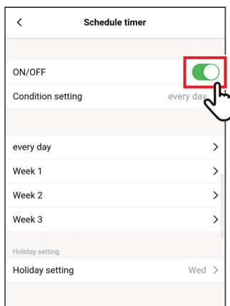
**1** Alterne entre [Ligar (ON)] e [Desligar (OFF)] usando um interruptor [ON/OFF] indica o estado [Ligar (ON)].
